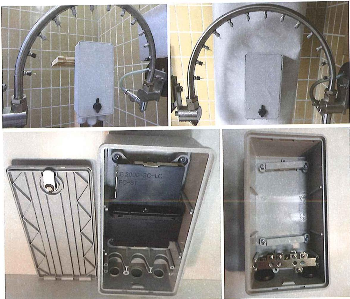
Abbildung 5: Prüfung IPX4
